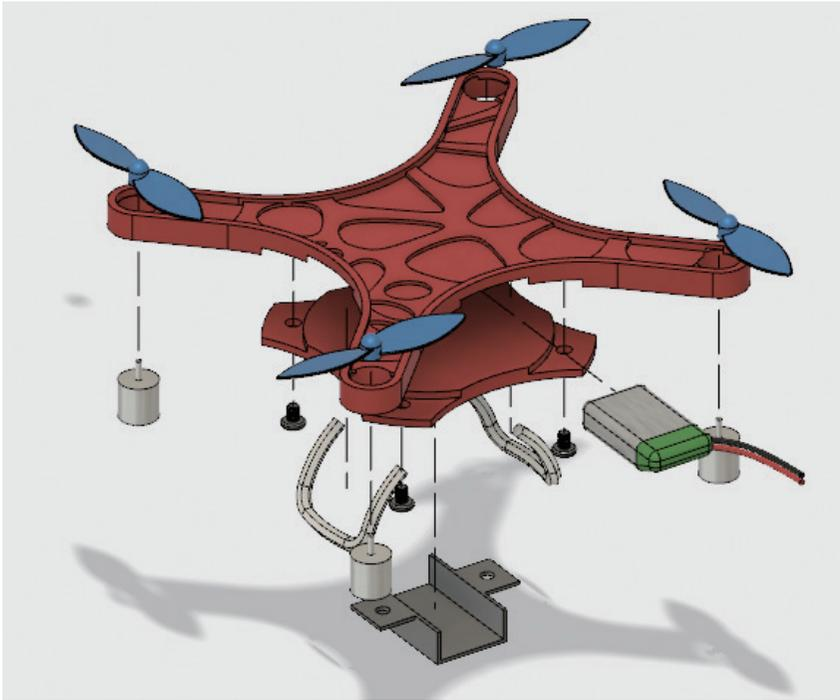
すでに作成された部品を組み立てるため、各部品がどのように組み合わせるのか（固定されるのか、スライドするのか、回転するのか）という「ジョイント」を設定することで組み立てられます。
