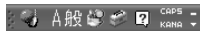
図1-13 半角文字の入力モード(英数字入力モード)に切り替えると、言語バーに「A」と表示されます。
